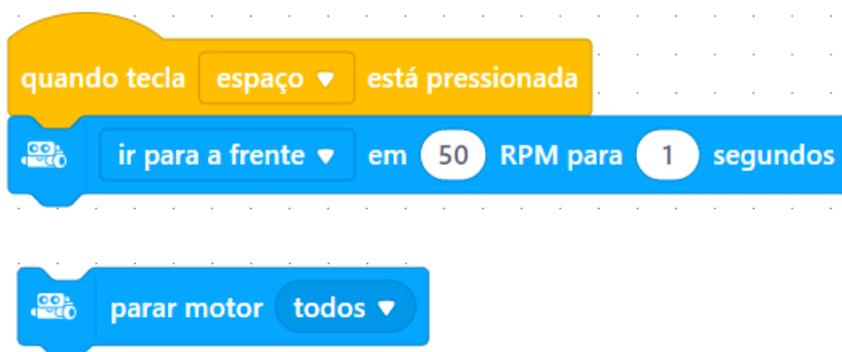
O bloco de programação anterior, permite-lhe fazer com que o robô pare de se mover. Este pode ser um bloco útil durante uma fase de teste. Caso, um programa não funcionar como esperado, pode usar este bloco para fazer o robô parar imediatamente.
